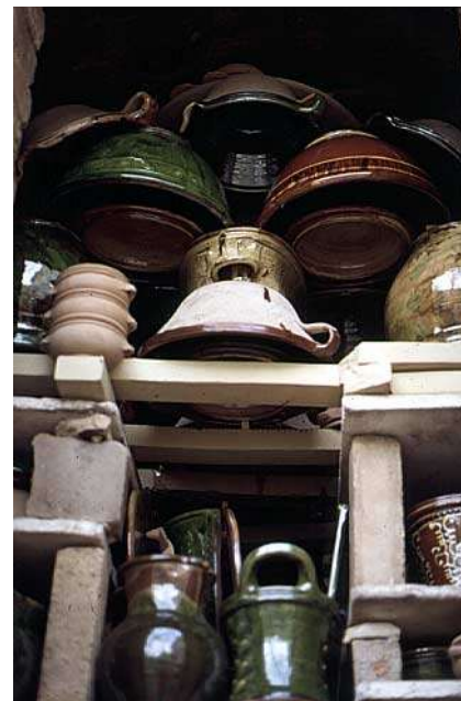
Enfournement des pièces dans le four. Ci-contre : défournement des pièces encore chaudes; au premier plan, formes du XIV e en jaune ou vert, décor à cotes en relief, copies de cruches médiévales (fouilles Cour Carrée) commandées par Le Louvre.
