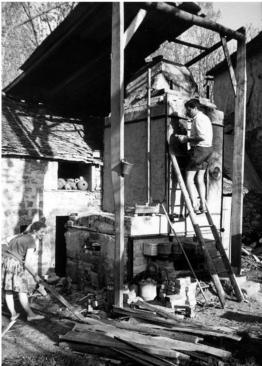
Cuisson au bois du four à flamme directe de 3 m 3 . Sylvie charge les dosses de pin brut longues de 2 mètres dans l'alandier qui s'étend sous toute la sole de la chambre. François surveille la cuisson par un regard situé en haut du four et retire de temps à autre des anneaux témoins, seul contrôle de la bonne cuisson de l'alquifoux. Le four monte à environ 1000° en 15 heures.
