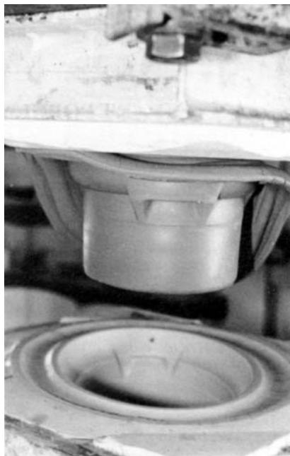
*Presses, calibreuses prennent le relais du tour lorsqu'il s'agit de passer à la petite série à partir d'une forme prototype, créée par un membre de la famille.*
